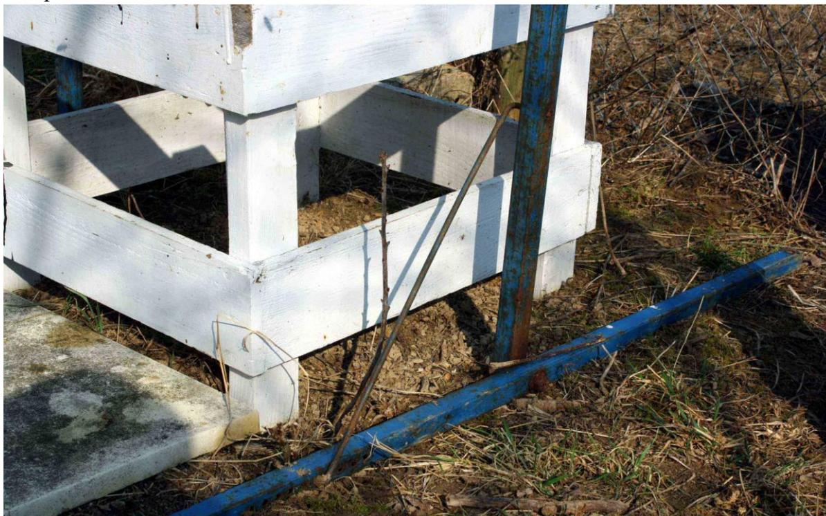
Les pieds sont articulés et inclinables pour s'adapter au terrain avec des crochets raidisseurs qui s'emboîtent selon l'inclinaison avec des trous en ligne.
