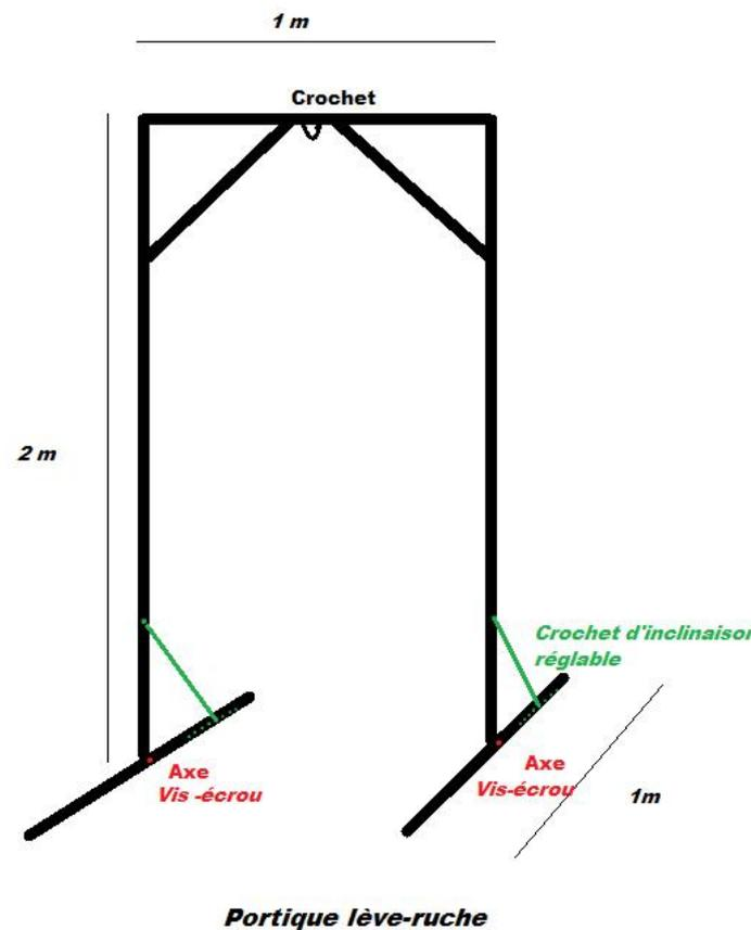
Il est fait en tubes carrés acier 25 mm soudés avec un crochet de suspension pour accueillir un palan premier prix.
